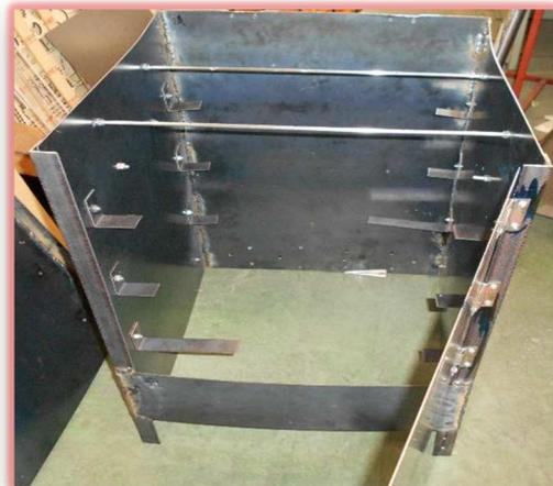
・鉄板の切断、穴あけ、組み立て、溶接作業などを駆使し、オリジナルの「燻製機」を設計・製作。
