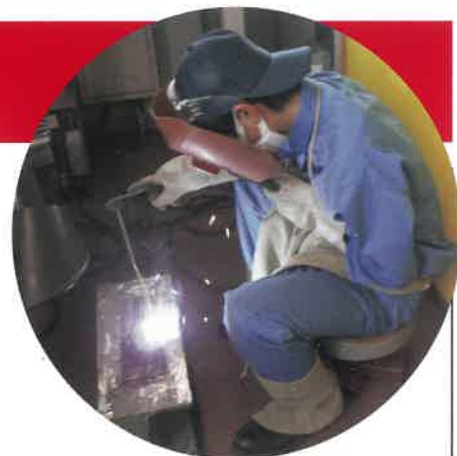
アーク溶接実習
